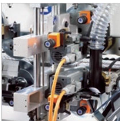
Il **Gruppo Refilatore Sovrapposto** riduce l'eccedenza del bordo nella parte superiore e inferiore del pannello. Garantisce la finitura del massello in un solo passaggio.
