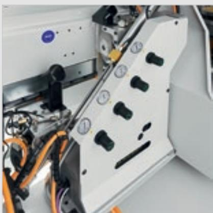
Affidabilità e precisione di taglio grazie al **Gruppo Intestatore** completo di due motori con scorrimento su 2 guide lineari, per eliminare l'eccedenza del bordo in testa e coda del pannello.
