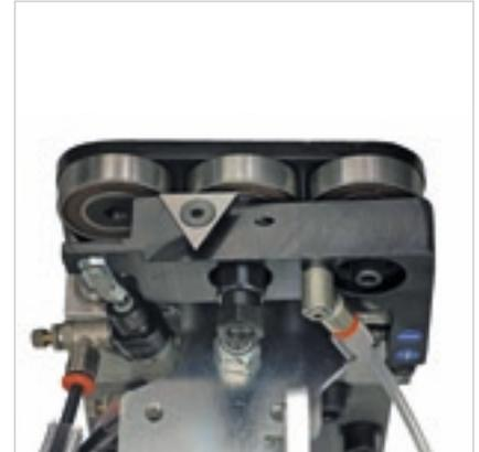
Il **Gruppo Rachiacolla** che rimuovere gli eccessi di colla nella parte superiore ed inferiore del pannello, è l'unico sul mercato dotato di 4 cilindri pneumatici per un'elevata qualità di finitura.
