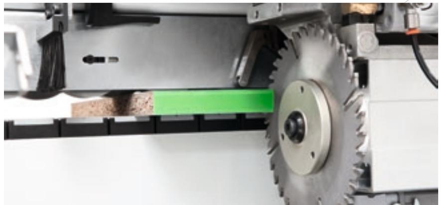
Affidabilità e precisione di taglio grazie al **Gruppo Intestatore** per eliminare l'eccedenza del bordo in testa e coda del pannello. Il Gruppo Intestatore prevede di serie il **Sistema Flex** che consente in automatico una regolazione dell'eccedenza del bordo.
