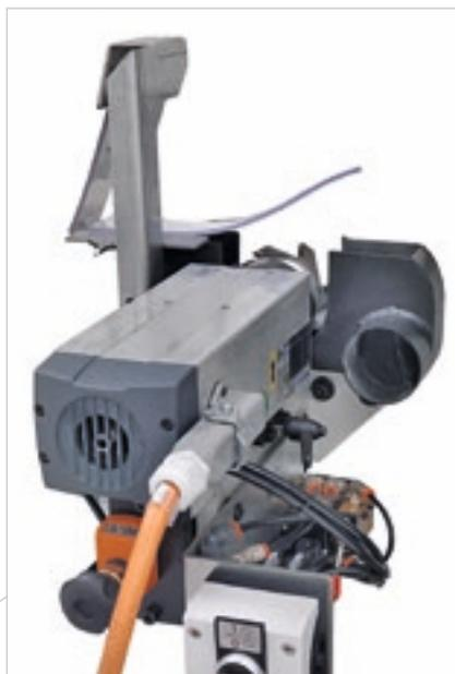
Il **Gruppo Fresatore** permette di realizzare la scanalatura e la fresatura sulla superficie inferiore del pannello.
